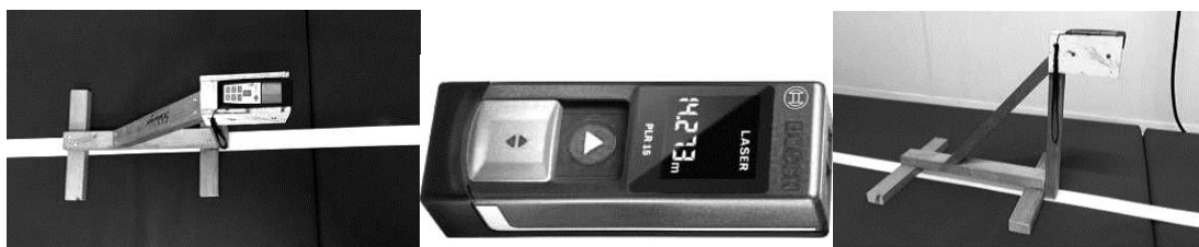
Фигура 2. Статив и лазерна ролетка за измерването
